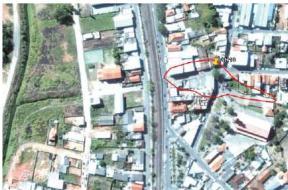
Figura 68 - Estrangulamento do Capão do Melo provocando refluxo das águas no Centro Fonte: CPRM, 2012.
