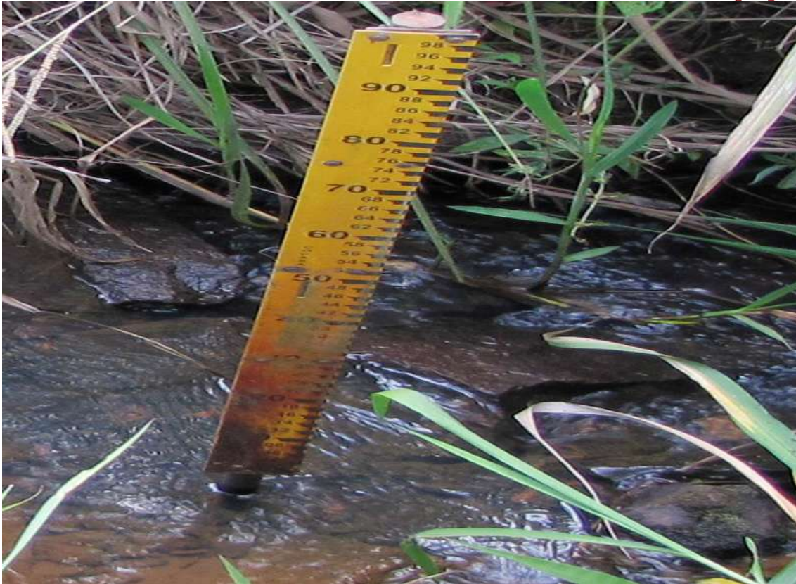
Figura 15 - Régua de nível do Córrego do Vau Fonte: Moradores de Carandaí, 2015.
