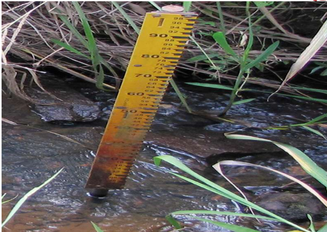
Figura 88 - Régua de nível do Córrego do Vau Fonte: Moradores de Carandaí, 2015.
