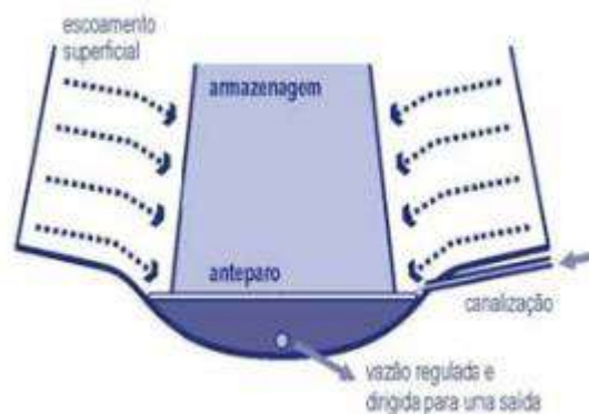
Figura 33 - Vale de Retenção Fonte: Azzout et al, 1994, por CH2MHILL, 2002
